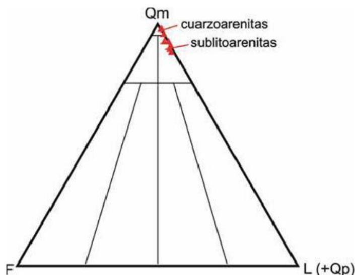
Figura 10.- Diagrama Composicional de las Areniscas de la Fm Solari. Qm:F:L+Qp^2 de Folk et al ,1970
